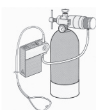
図7. 呼吸同調装置 (デマンドバルブ)
