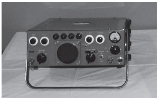
写真1 携帯型超音波診断装置 (Aモード法を用いた、当時としては革新的に小型化された超音波診断装置)
