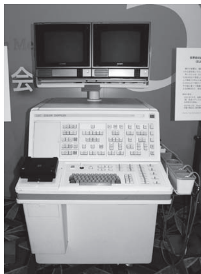
写真2 世界初のカラーDプラ診断装置(心臓専用) (電子セクタ探触子を備え、心腔内を流れる血流を二次元リアルタイム表示できる、世界初の超音波診断装置であった)
