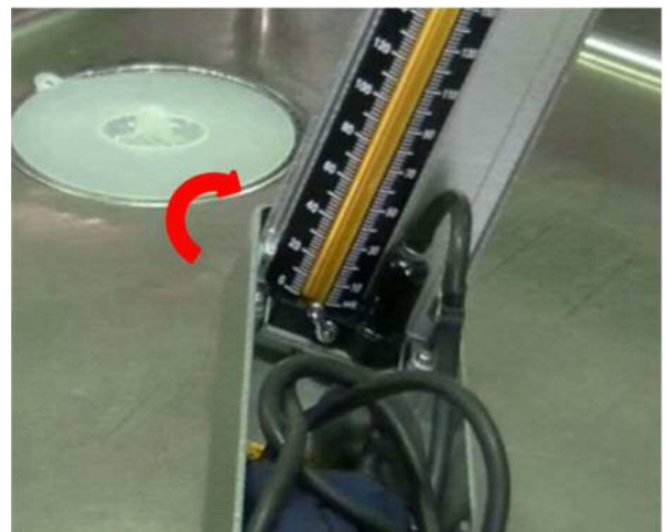
④下がり切ったら右45度傾けます。 (タンク内に水銀が入り切ります。)
