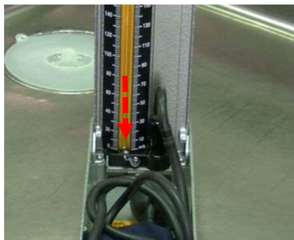
③目盛りの水銀が、みるみるタンク内に戻ります。(目盛りが下がりきるまで待ちます。)
