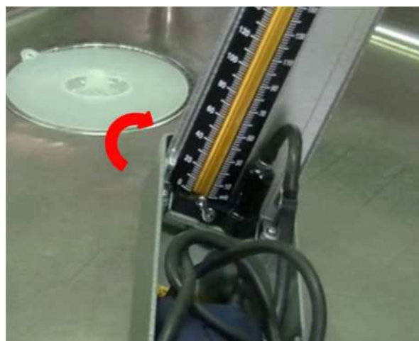
④下がり切ったら右45度傾けます。 (タンク内に水銀が入り切ります。)
