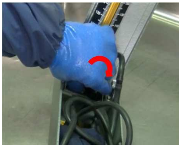
⑤右45度に傾けた状態で、水銀コックを右に戻します。
